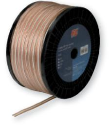
Conducteurs en cuivre désoxygéné à 99,99 % (OFC), brins fins, plusieurs sections disponibles. Faible effet capacitif du fait de l'espacement entre les deux conducteurs.
